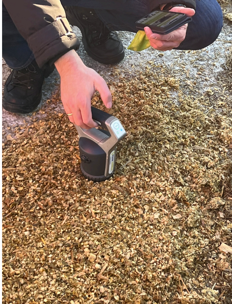
Futterbeprobung binnen Minuten - das verspricht das mobile NIR-Gerät. Was es wirklich kann, wird gerade vom Maschinenring Region Innviertel getestet.
