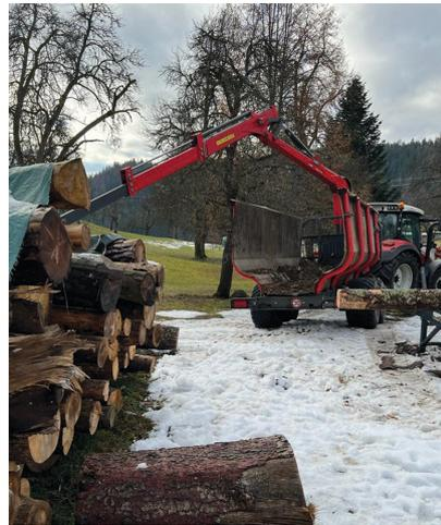
Thomas Slanitz hat sich einen Uniforest Holzspaltautomat Titan 40/20 angeschafft. Mit diesem Aggregat kann er bis zu einem Durchmesser von 40 cm schneiden und spalten. Das Brennholz sollte vorher entsprechend ausgeformt und vorbereitet sein. Mit dem Förderband kann entweder auf Haufen oder in Kipper geladen werden. Für eine Anfahrt sind jedoch entsprechende Mengen notwendig.
