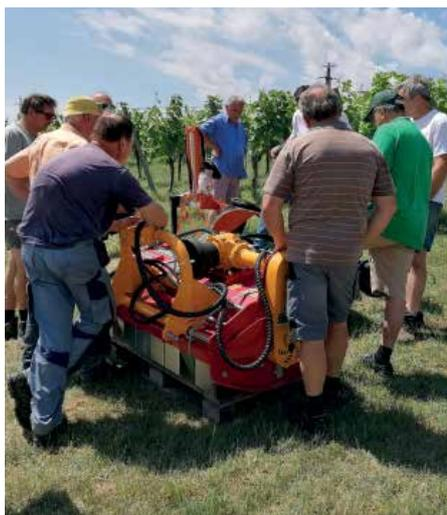
**Der RO-Entlauber Vitipluse.** Ein Highlight der Veranstaltung war die Vorführung einer Maschine zum Entlauben der Rebstöcke mittels Druckluft. Die Vorgehensweise wurde von Spezialisten sowohl fachkundig erläutert als auch im Zuge der Vorführungen praktisch nähergebracht.
