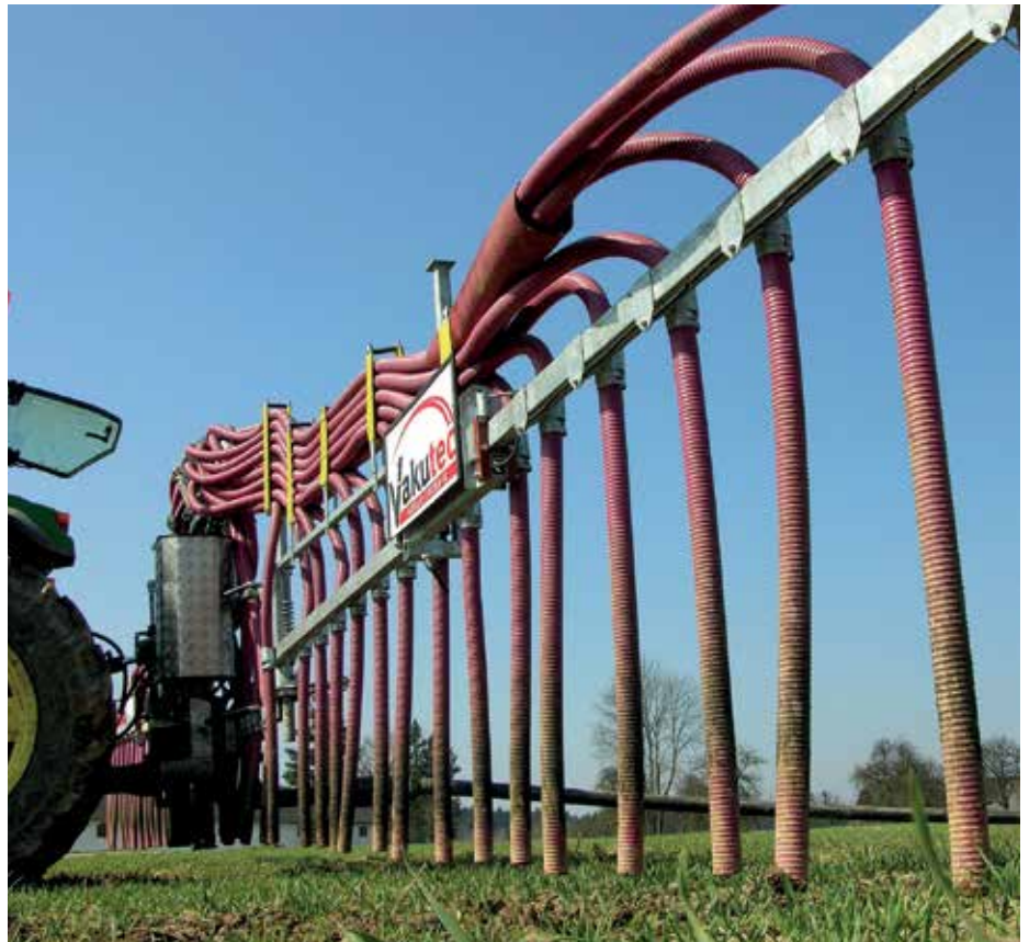
Bodennahe Ausbringung: Gülleverschlauchung mit Schleppschlauchverteiler
