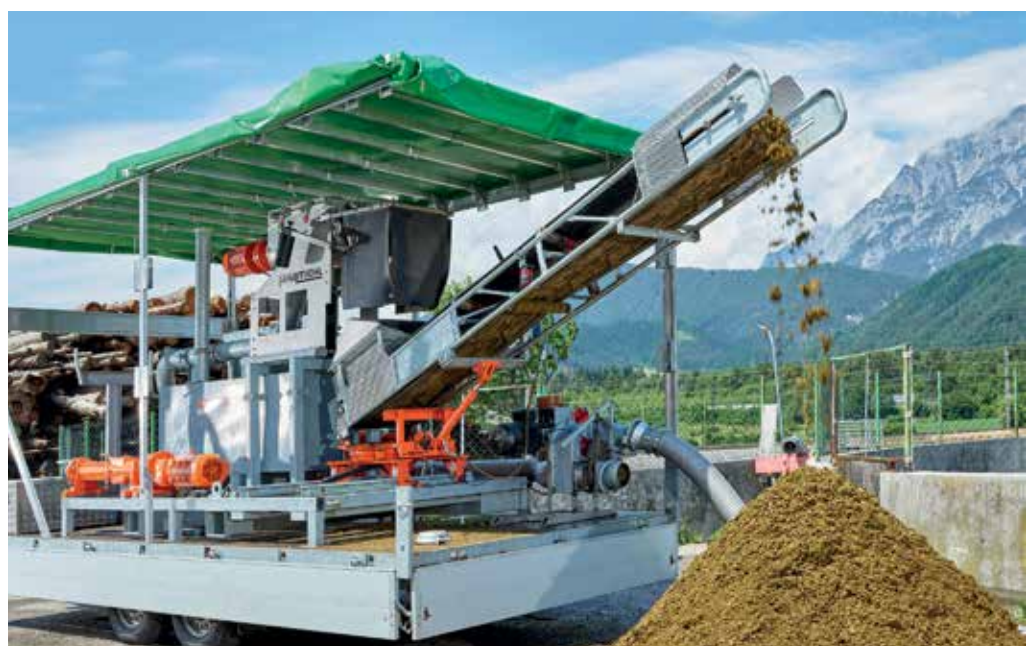
Mechanische Aufbereitung der Gülle mittels mobilem Gülleseparator
