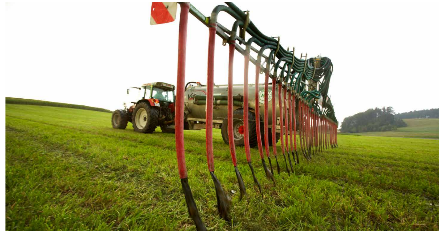
Bodennahe Gülleausbringung mittels Schleppschlauch
