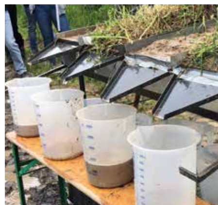
Praxisnahe Versuchsanordnung - Wasserspeicherung, verschiedene Bodenprofile
