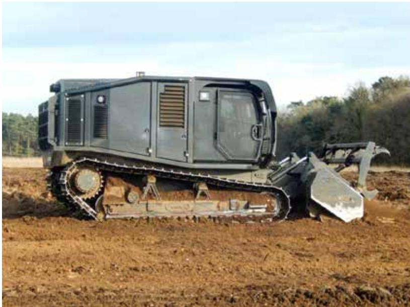
Arbeitstiefe je nach Kundenwunsch bis zu 15 cm, dann kann das Mulchmaterial gut mit dem Erdmaterial vermischt in den Boden für eine Verrottung eingearbeitet werden
