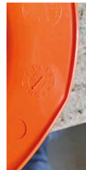
In der Innenschale des Helms gibt das Prägedatum die Herstellung an. Eine Nutzungsdauer von vier Jahren ab dem Prägedatum ist der Regelfall.
