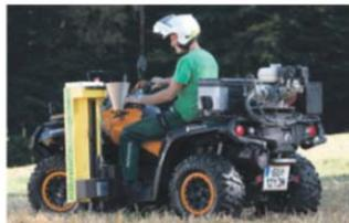
Per Quad oder Traktor nimmt der Maschinenring Bodenproben, um den Nährstoffbedarf genau festzustellen.
