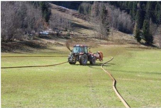
Durch das geringe Gewicht der Gülleverschlauchung kann diese sehr gut auf steilen Flächen und auf schlechter befahrbaren Böden eingesetzt werden. Verschlauchungssysteme eignen sich für Betriebe mit arrondierten Flächen, wobei ein Umkreis von 1km abgedeckt werden kann.
