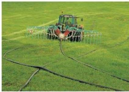
**SCHLEPPSCHLAUCH UND CO:** Durch die entsprechende Düngetechnik kann hohen Stickstoffverlusten vorgebeugt werden – dies nützt der Umwelt und steigert den Ertrag.
