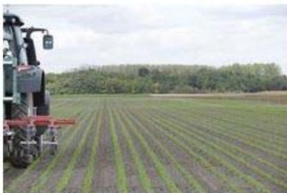
Das Maschinenring Mobil RTK Signal ermöglicht z.B. sehr geringe Überlappungen bei der Bodenbearbeitung – das senkt den Treibstoffverbrauch.
