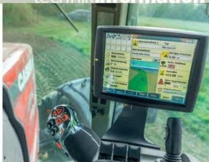
SATELLITENGESTÜTZTE LENKSYSTEME helfen dabei, die exakte Position zu halten und einer festgelegten Spur zu folgen.
