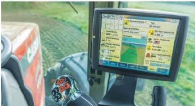
Lenksysteme können durch geringere Überschneidungen beim Säen oder Ernten Treibstoff sparen und so auch die Kosten senken. Der Maschinenring untersucht dazu die Möglichkeiten.
