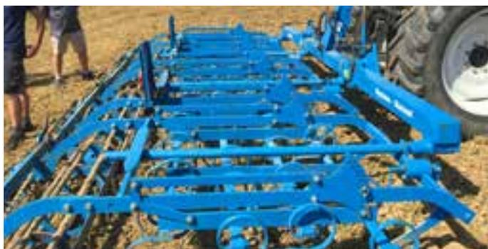
Maschinen zur ersten Bodenbearbeitung oder Saatbeetvorbereitung mit Scheibeneggen oder auch Leichtgrubber im Frühjahr.
