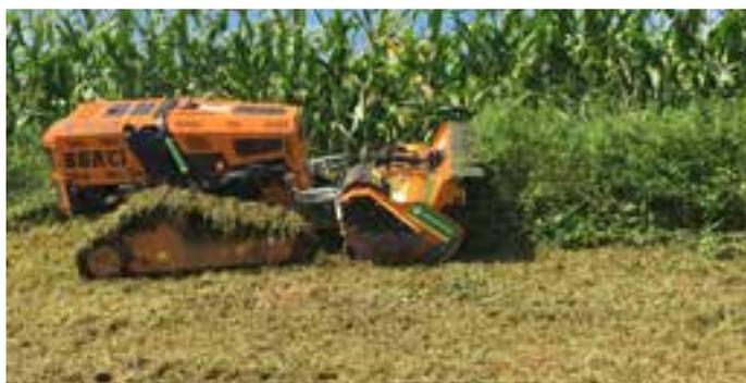
Ferngesteuerter Bergflächenmulcher oder Böschungsmulcher optimal auch für Rückhaltebecken oder Feuchflächen.
