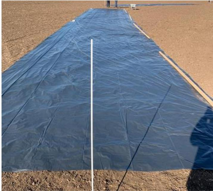
Abbildung 20: Plane zur Verstärkung des Kontrasts zwischen Untergrund und Düngerkörnern
