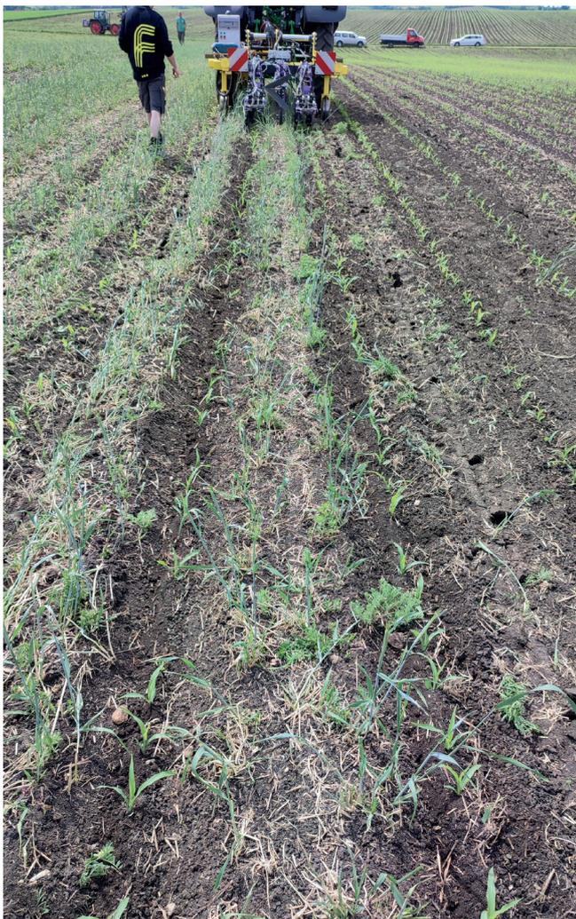
**Abb. 2: Prototyp einer In-Row Hacke der Fa. Feldklasse (DE) mit einem KI-gestützten Kamerasystem der Fa. Ullmanna (CZ)**
