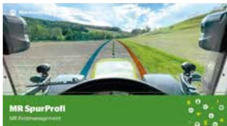
Mit RTK-Einsatz bei Lenksystemen werden Genauigkeiten von ca. zwei Zentimetern erreicht. Mit Hilfe von AB-Geraden ist ein exaktes Anschlussfahren möglich. Jedoch gerade im Bereich der Feldaußengrenze oder bei unförmigen Feldstücken ist nach wie vor eine manuelle Steuerung notwendig. Mit dem Maschinenring SpurProfi-Paket werden selbst aufgenommene Feldkonturen aufbereitet und dienen als Basis für ein effizientes Fahrspurmanagement.
