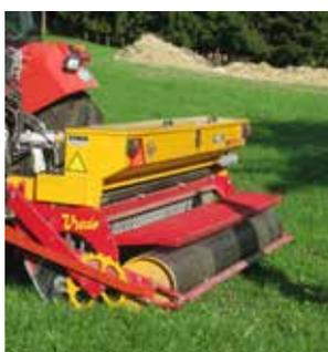
Scheibenschlitzschar-Sämaschine 2 m
