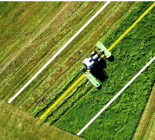
**Durch Front-und-Heck-Kombination verschiebt sich die Fahrlinie auf den Mittelpunkt der gesamten Arbeitsbreite (gelbe Linie). Diese Fahrspur ist am Bild aktiv. Der Traktor bleibt selbstständig auf zwei Zentimeter Genauigkeit auf dieser errechneten Spur.**
