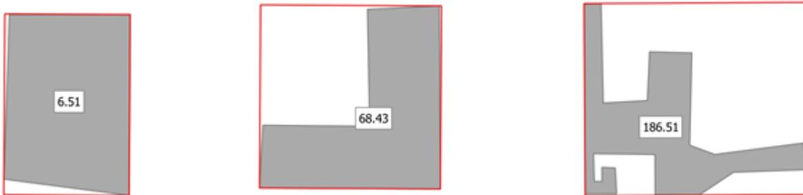
Abbildung 1: Drei Feldstücke von der jeweiligen minimal begrenzenden Geometrie umschlossen und der Prozentwert der minimal begrenzenden Geometrie (Quelle: Ebner und Gruber, (2020).
