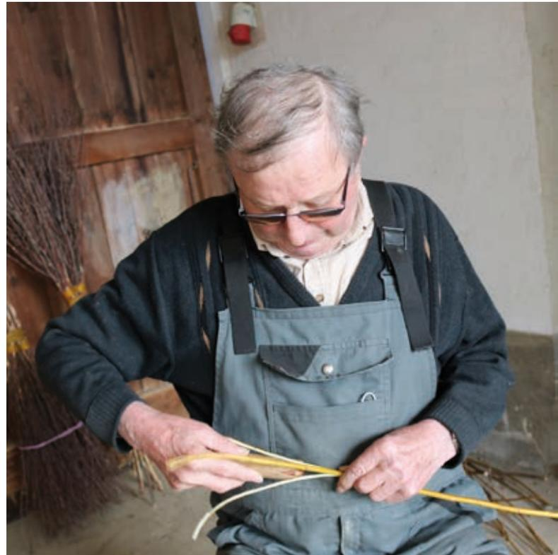
*Mit dem 3-fach Holzspitz wird die Weidenrinde gespaltet. Die Ahle ist ein wichtiges Werkzeug beim Besenbinden.*
