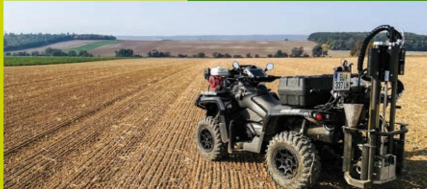
**Anschließende Beprobung mit dem Nährstoffmanagement-Quad der Maschinenring Agrar Concept GmbH in den kartierten Zonen. Die Bodenanalyse der Referenzpunkte dient als Grundlage für die Zonenbewertung.**
