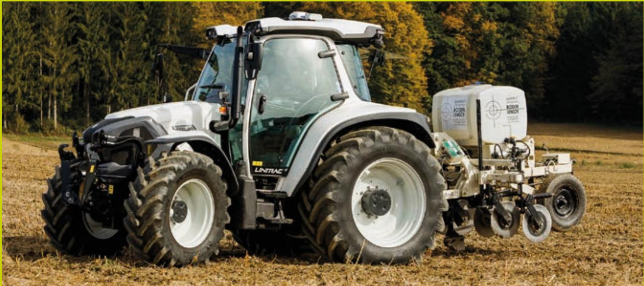
**Modernste Technik im Einsatz: Traktor (am Bild ein Lindner Lintrac 110) mit RTK Lenksystem (TraLink Pilot mit Maschinenring Mobil RTK-Signal) und dem VERIS Bodensensor aus dem BUMIS\*-Projekt.**
