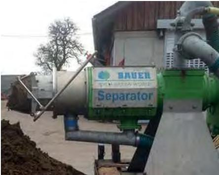
Die Gülle wird mit einer Schneckenpumpe entlang eines Siebkorb gedreht. Die Flüssigphase geht durch das Sieb nach außen und die Feststoffe kommen am Ende der Schnecke aus dem Sieb. Der Wassergehalt bei den Feststoffen kann durch die Klappe am Ende eingestellt werden.
