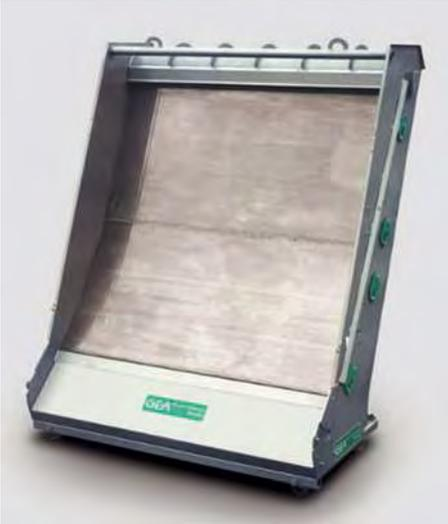
Über ein gebogenes, stehendes Sieb fließt die Gülle von oben nach unten darüber, die flüssige Phase dringt durch das Sieb und wird auf der Rückseite abgeschieden, während die Feststoffe auf der Vorderseite nach unten rutschen. Die Gülle muss gleich-
