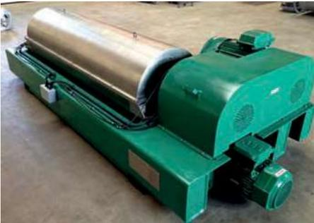
Über das unterschiedliche Gewicht der Stoffe wird in der Zentrifuge der Feststoff von der Flüssigphase getrennt. Die Abtrennleistung kann über die Drehzahl gesteuert werden. Vorteile: Hohe Literleistung. Nachteile: Flockmittel für die Feststoffphase erforderlich.
