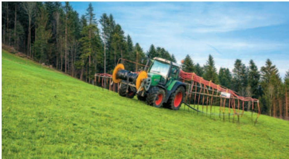
**Von allen emissionsmindernden Ausbringungstechniken wird der Schleppschlauch bereits am häufigsten eingesetzt. Bei diesem Verfahren wird die Gülle mittels parallel verlaufendem Schlauchsystem in Streifen auf dem Boden ausgebracht.**
