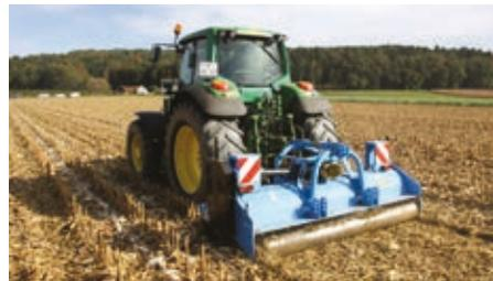
Anbaugeräte sind unter bestimmten Voraussetzungen mit reflektierenden Warnmarkierungen zu kennzeichnen..
