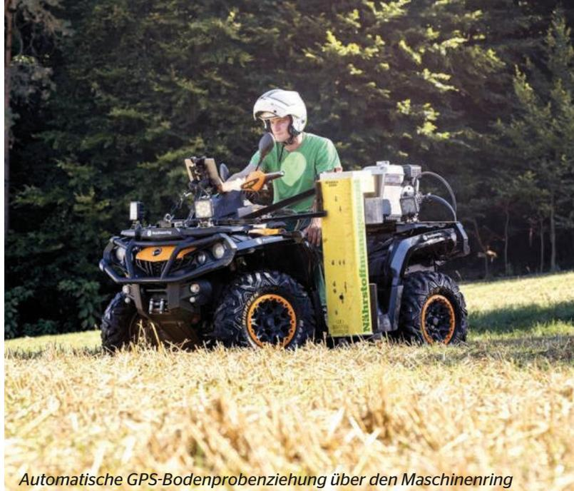
*Automatische GPS-Bodenprobenziehung über den Maschinenring*
