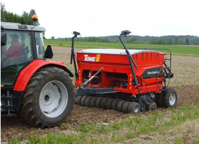
Tume Direktsämaschine (Scheibenschlitzsämaschine)
